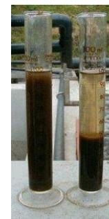
浄化処理の状態を把握するため、汚泥の沈殿状況や上澄み液の状態を観察
