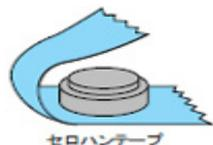
図 2.1.1 ボタン電池の絶縁方法例<sup>8</sup>
