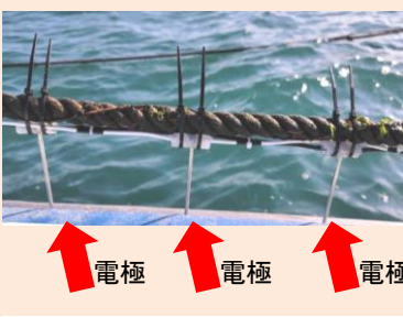
養殖用ロープに 電気刺激 を発する電極を設置
