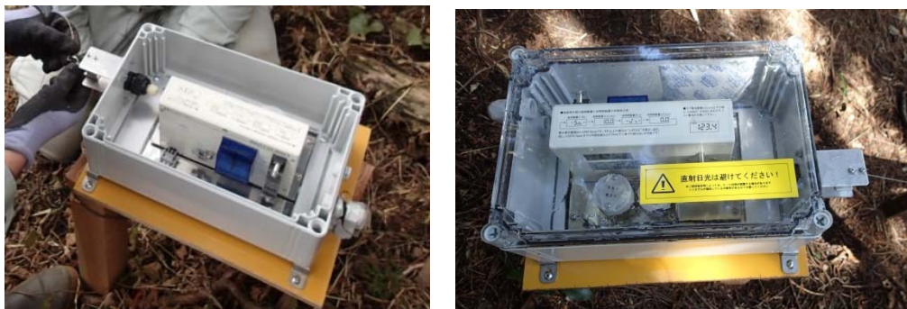
写真 3.1 伸縮計本体（伸縮データ集録装置）と保護箱
