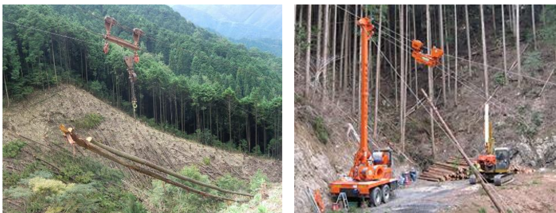
架線系による木材搬出
