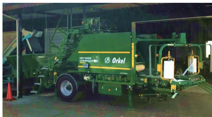
写真1 マルチコンパクター (Orkel 社 MC1000) の外観
