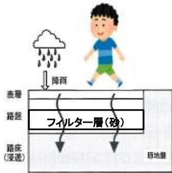
【透水性舗装 イメージ図】
