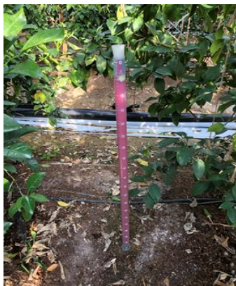
写真1 土壌水分目視計設置の様子
