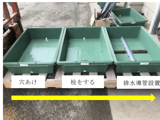
図4 いぐさ用プラスチックコンテナの製作過程 (最右が完成形)
