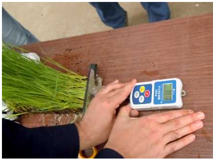
写真 1：引っ張り法によるルートマット強度評価
