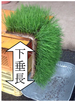
写真 2：ぶら下げ法によるルートマット強度評価
