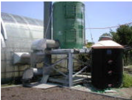
図2 簡易悪臭低減装置
