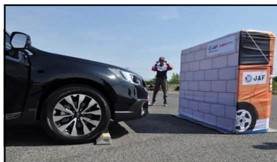
【ペダル踏み間違い時加速抑制装置】
