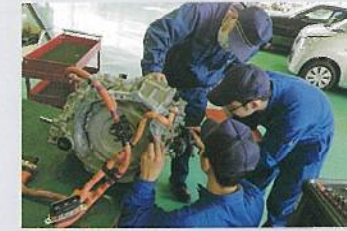
HVモーター分解実習
