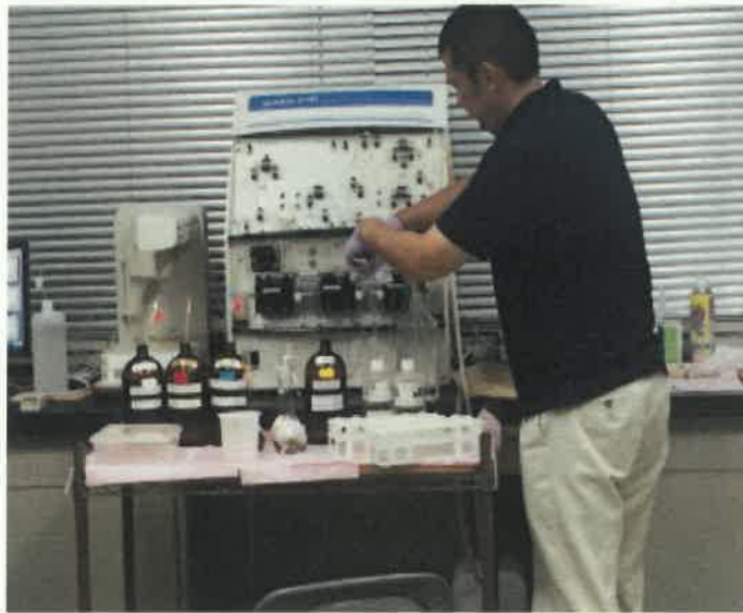
(1) オートアナライザー の設定状況
