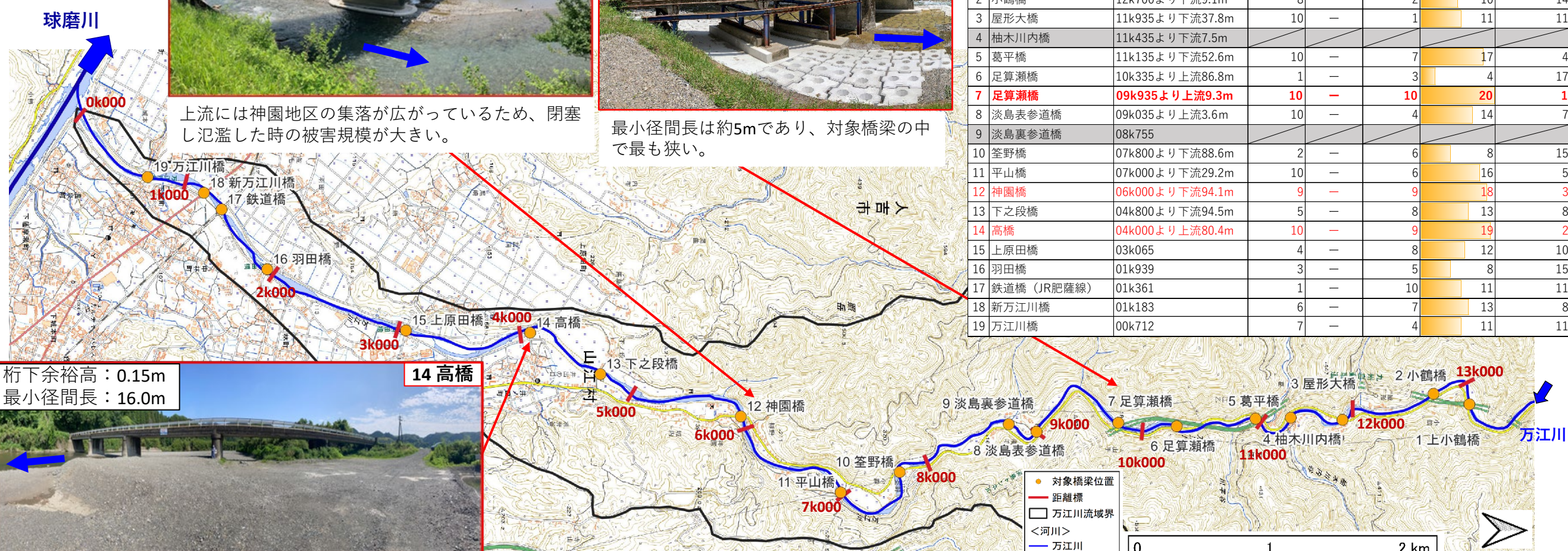
下流の堰の影響で橋梁直下で土砂が堆砂している。
