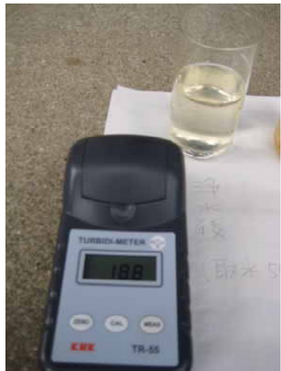
写真-4 除鉄機通過後の水の濁度 (18.8)
